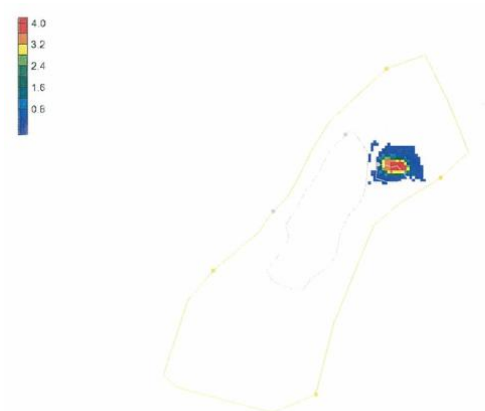
图 6.2-18 设定情景 1 年后氨氮污染预测
