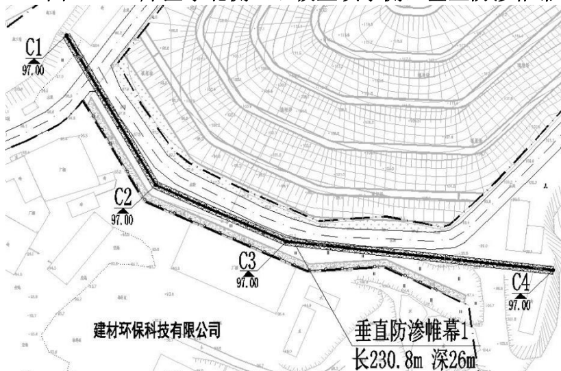
图 4.2-4 库区南侧（垃圾副坝侧）垂直防渗帷幕
