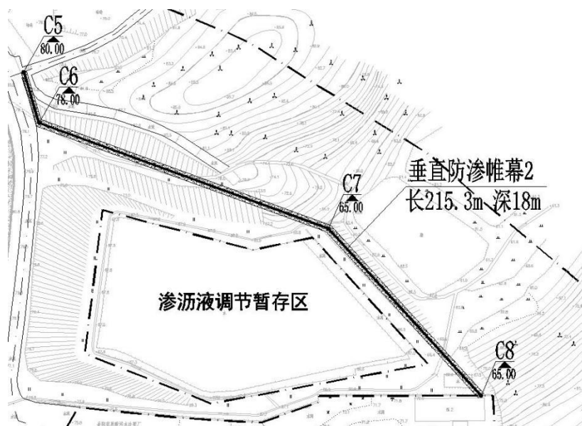
图 4.2-3 库区东北侧（垃圾主坝东侧）垂直防渗帷幕
